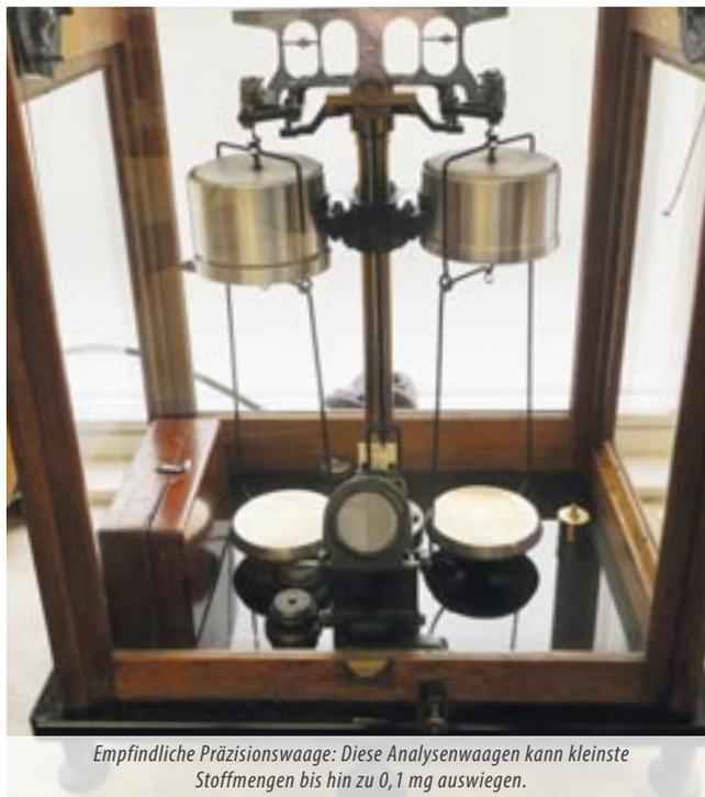
*Empfindliche Präzisionswaage: Diese Analysenwaagen kann kleinste Stoffmengen bis hin zu 0,1 mg auswiegen.*
